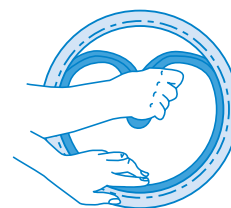
Installatie van de afdichting zonder voorafgaande smering
