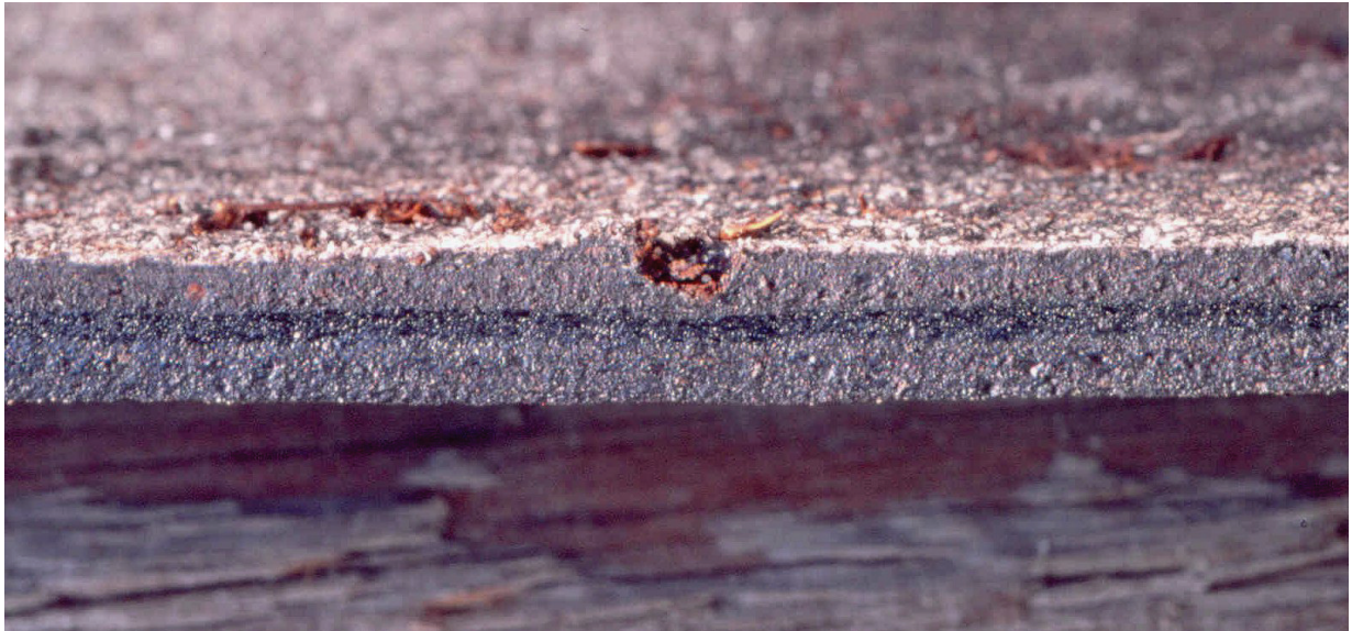
Abb. 7: Schnitt durch die Bahn mit Wurzeleindringung (Detail)
