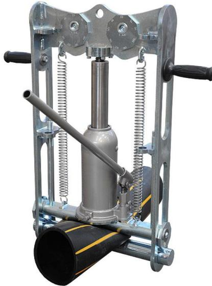
Le **SQUEEZER 63-200** est un presse-étoupe hydraulique, très efficace et utile sur site, pour arrêter l'écoulement de gaz ou d'eau dans les canalisations en PEHD de **63 à 200 mm, SDR 11 et SDR 17**.
