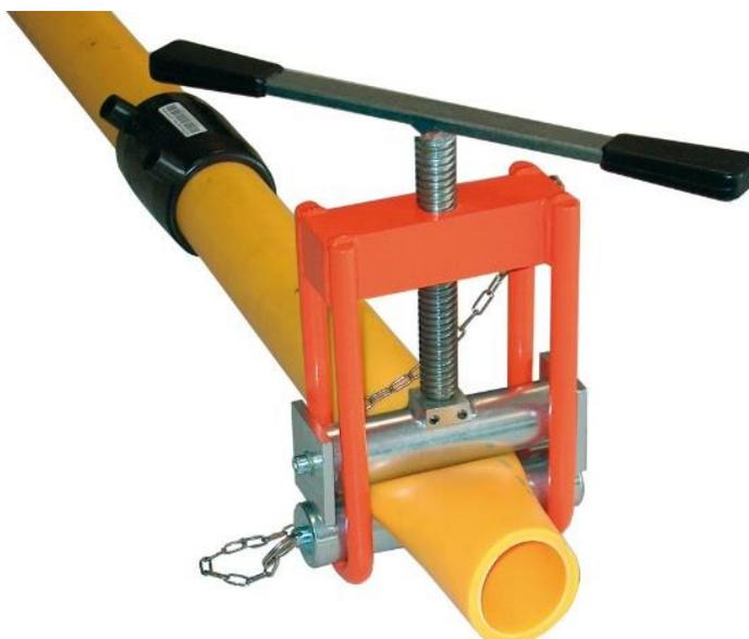
Le **SQUEEZER 63** est un outil manuel. Facile à utiliser sur site, il peut arrêter l'écoulement de gaz ou d'eau dans les tuyaux en polyéthylène de **16 à 63 mm, SDR 11 et SDR 17**.
