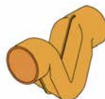
Siphon extérieur en V DN 100
