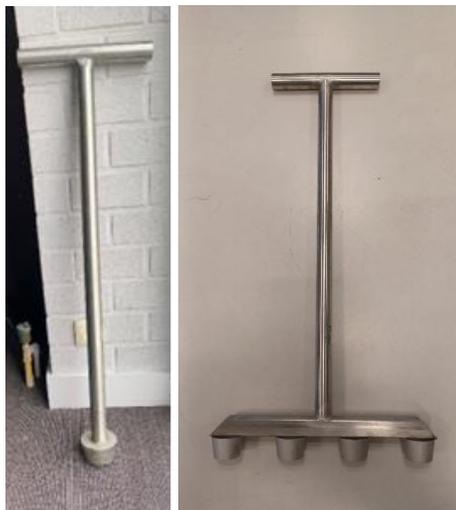
Dans les deux cas, les petits opercules tomberont dans les ouvertures de la dalle en béton. Ils peuvent ensuite être facilement retirés à la main, avec un outil pointu ou un aspirateur. Même s'ils ne sont pas retirés, le revêtement perméable à l'eau reste conforme à la norme PTV126.
