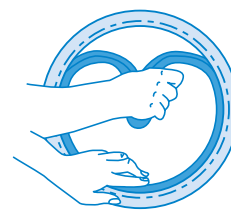
Montage du joint sans lubrification au préalable
