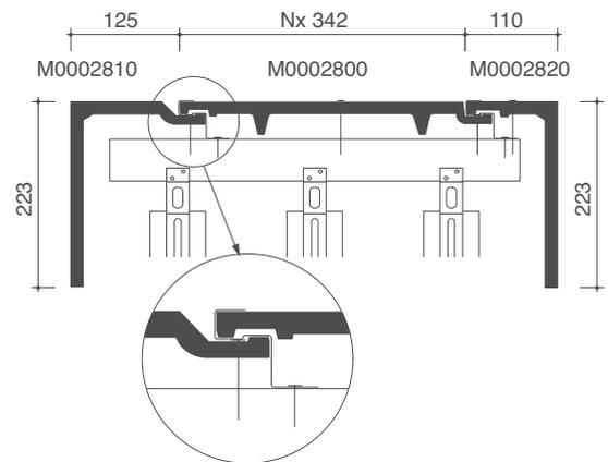
**PLAN DE POSE TRANSVERSALE DE LA TOITURE
