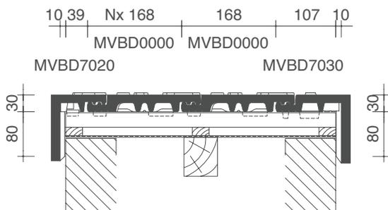
**PLAN DE POSE TRANSVERSALE DE LA TOITURE
