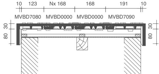
**PLAN DE POSE TRANSVERSALE DE LA TOITURE
