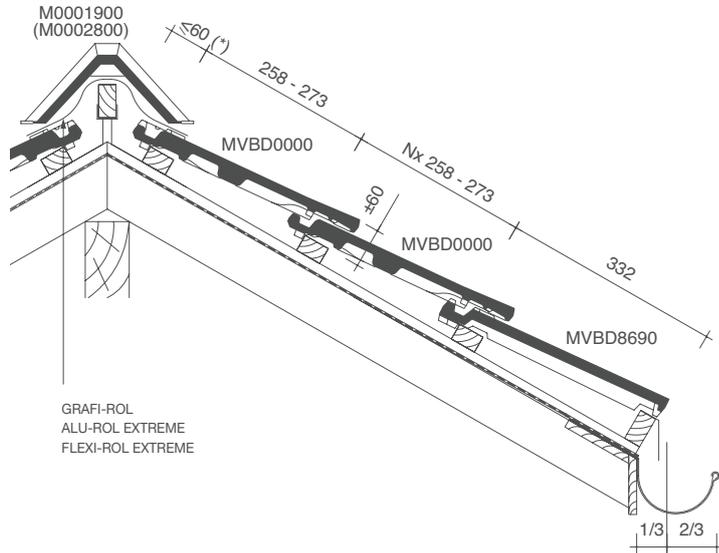
**PLAN DE POSE TRANSVERSALE DE LA TOITURE
